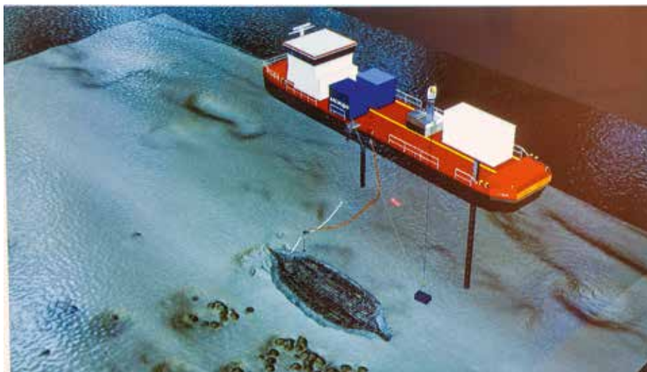
Bergungsanimation aus dem Vortrag: das im Fluss mit versenkbaren Pfählen strömungssicher verankerte Bergungsschiff liegt knapp über dem Wrack. Die Position des Schiffes blieb dadurch fest, eine wichtige Voraussetzung für die sichere Arbeit der Taucher. (Grafik: Pawel Stencel von Archcom; Foto: BZ)
