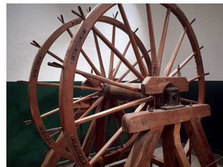
Handwinde mit doppeltem Handrad, aus einem Hamburger Hafenspeicher. Das große Handrad bietet bis zu 4 Männer Platz, für sehr schwere Lasten.
