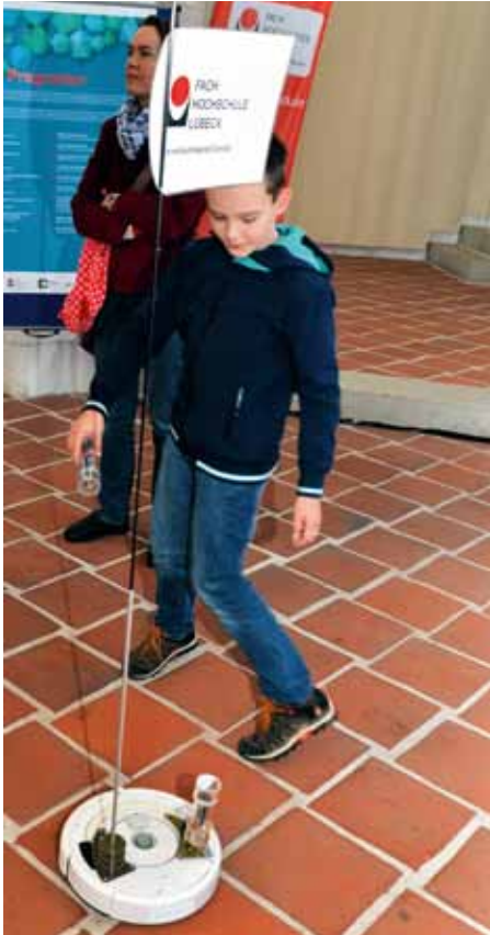
Raumerkundungsroboter; eigentliche Aufgabe: digitale, raumbezogene Informationsgewinnung, um vernetzte Systeme zu simulieren
