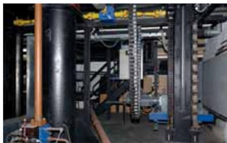
Vorne Hydraulikzylinder, hinten Führungsstützen mit Zahnstange und Ausgleichswelle (gelb) (Fotos: Sidney Smith)
