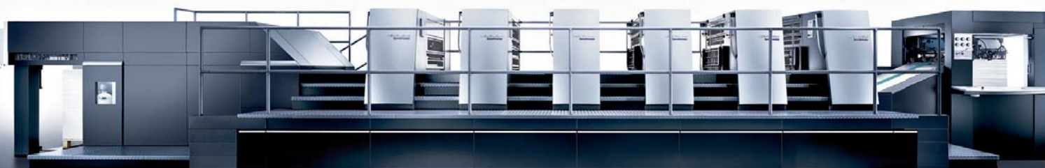
Druckmaschine der Fa. Heidelberg Speedmaster XL-105-5+L · Bogenformat bis 75 cm x 105 cm
